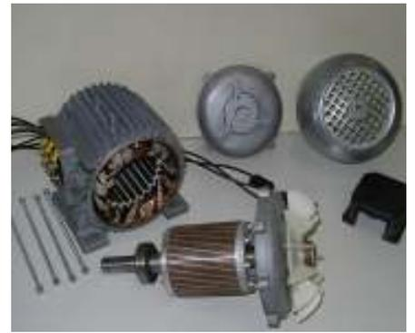
*Componenti di un motore elettrico*
