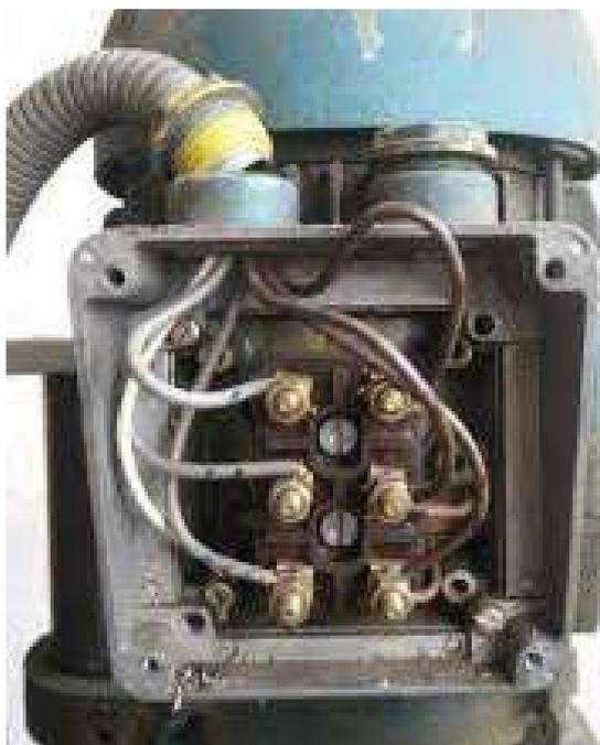
*Morsetti di alimentazione di un motore elettrico*
